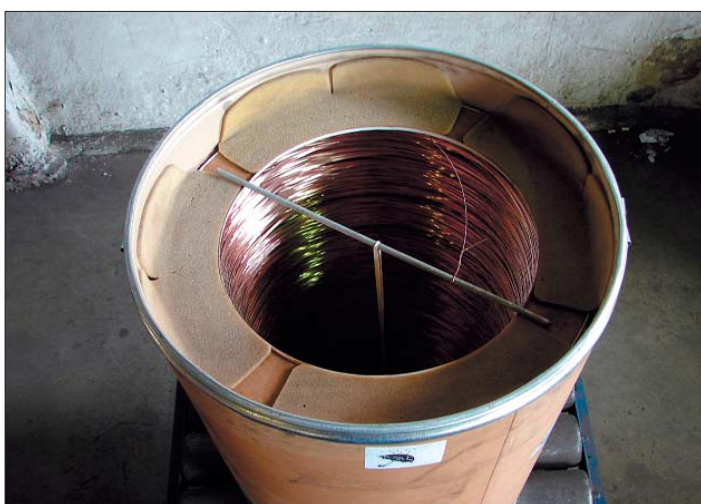
Rys. 6. Beczka z drutem przed nałożeniem pokrywy
