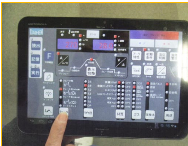
Rys. 4 Bezprzewodowe sterowanie źródłem prądu Welbee M400L z wirtualnego panelu sterowniczego na urządzeniu typu tablet
