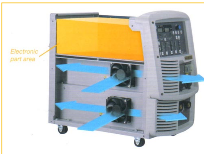
Rys. 6 Nowa innowacyjna koncepcja budowy urządzeń Welbee. Wszystkie elementy elektroniczne wrażliwe na pyły i zanieczyszczenia zostały zamknięte w jednej przestrzeni hermetycznej osłonie. Ilość zanieczyszczeń przedostających się do tej strefy została zredukowana o 98%
